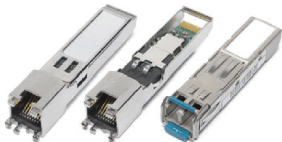
SFP モジュール: メタル線およびファイバー
